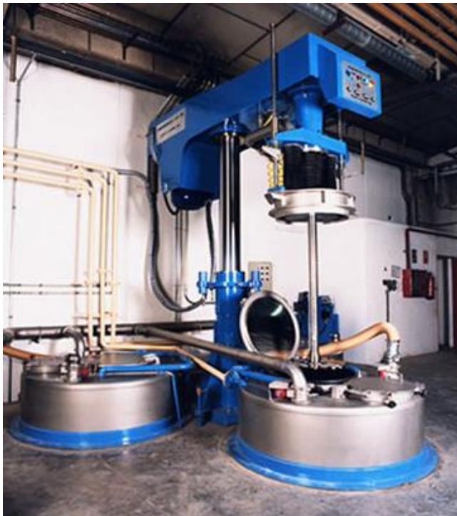
Рисунок 1 – Промисловий високошвидкісний диспергатор для приготування ґрунт-емалевих композицій
