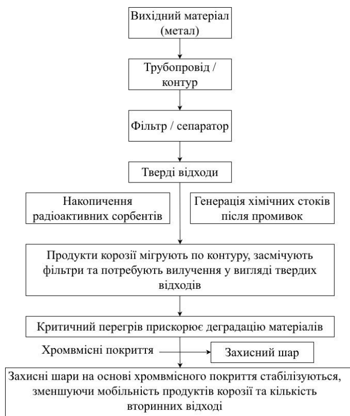
Рисунок 1 – Схема утворення, міграції та вилучення корозійних продуктів
