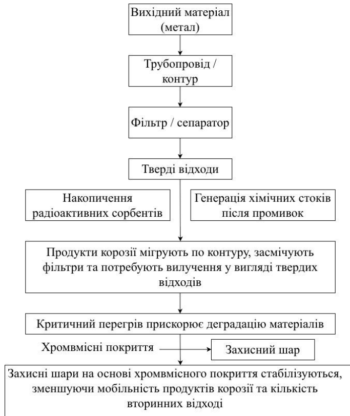
Рисунок 1 – Схема утворення, міграції та вилучення корозійних продуктів
