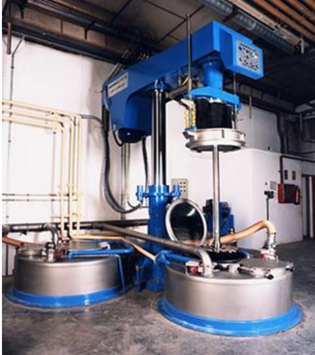
Рисунок 1 – Промисловий високошвидкісний диспергатор для приготування ґрунт-емалевих композицій
