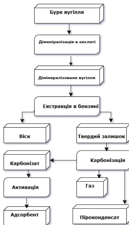
Рисунок 1 – Схема комплексної переробки бурого вугілля
