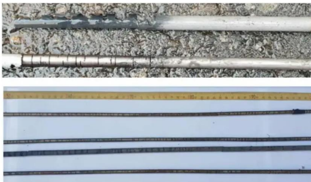
Рисунок 6 – Фото обладнання для влаштування відгалуджень (гілок) після його використання в промислових умовах за даними [10]
