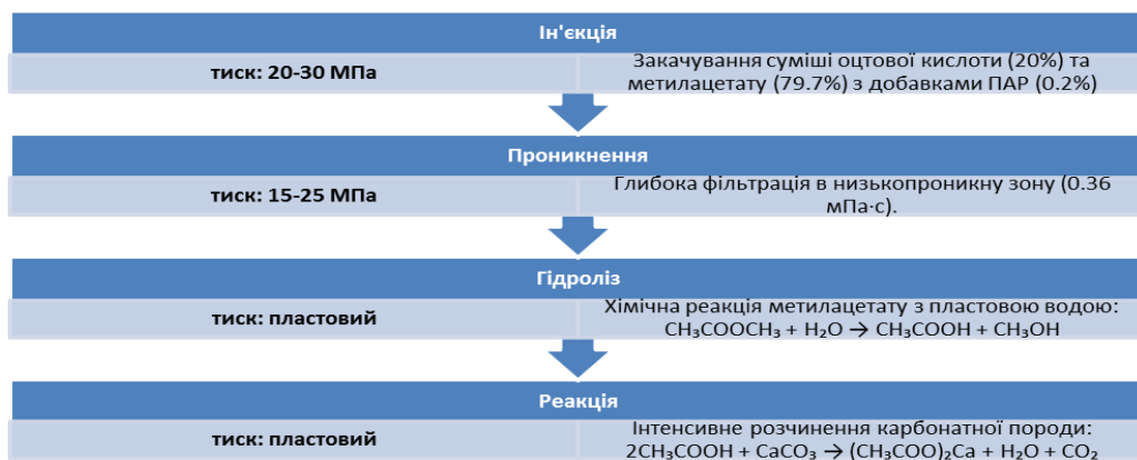
Рисунок 11 – Схема механізму дії кислотної системи на основі метилацетату в карбонатному колекторі
