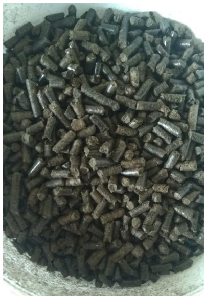
Рисунок 4 – Фотографія гранул паливних пелет із барди зовнішнього накопичувача діаметром 3 мм
