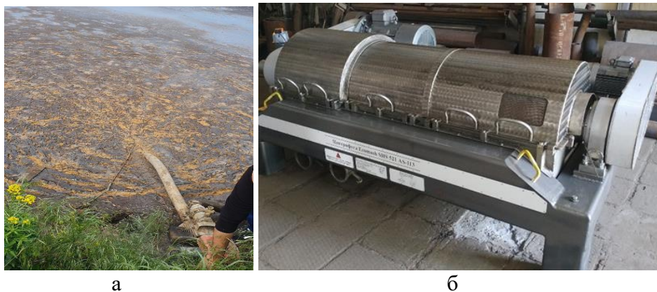
Рисунок 2 – Фотографії відбору барди із бардонакопичувача (а) та центрифугальної установки Ecomash SHS 521A-113 (б)
