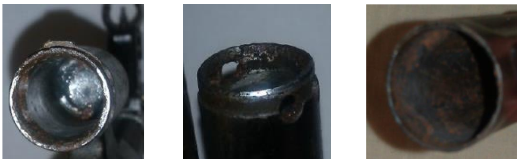
Рисунок 3 – Раковини розпалу на елементах газового тракту використаних автоматів
