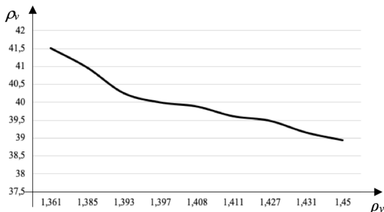
Рисунок 1 – Залежність електричного об'ємного питомого опору від уявної щільності
