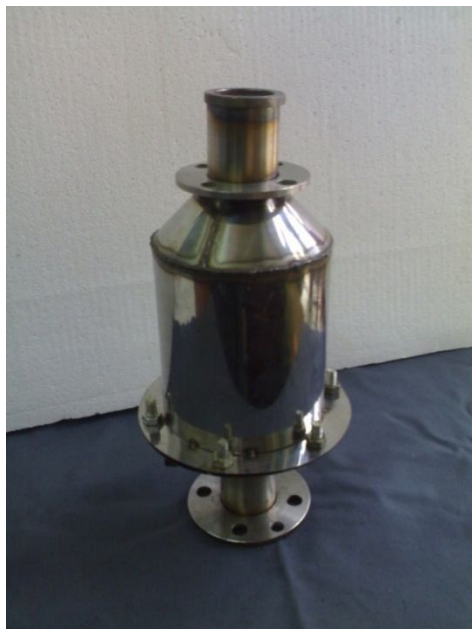
Рисунок 3 - Зовнішній вигляд розробленого блоку каталітичного нейтралізатора
