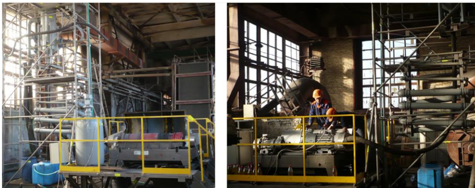
Рисунок 1 – Характеристика модуля очищення та зневоднення шламових вод під час промислових випробувань в цеху металургійного підприємства (ТОВ «НТЦ «Екомаш», Україна)
